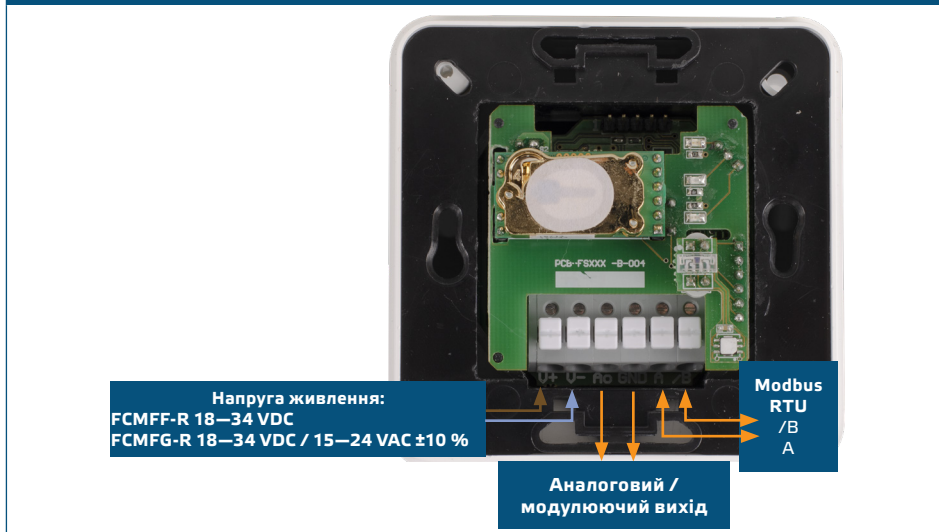
Мал. 1 Схема підключення
