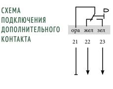
Резистивная нагрузка 3А, 230В Индуктивная нагрузка 1.5А, 230В
