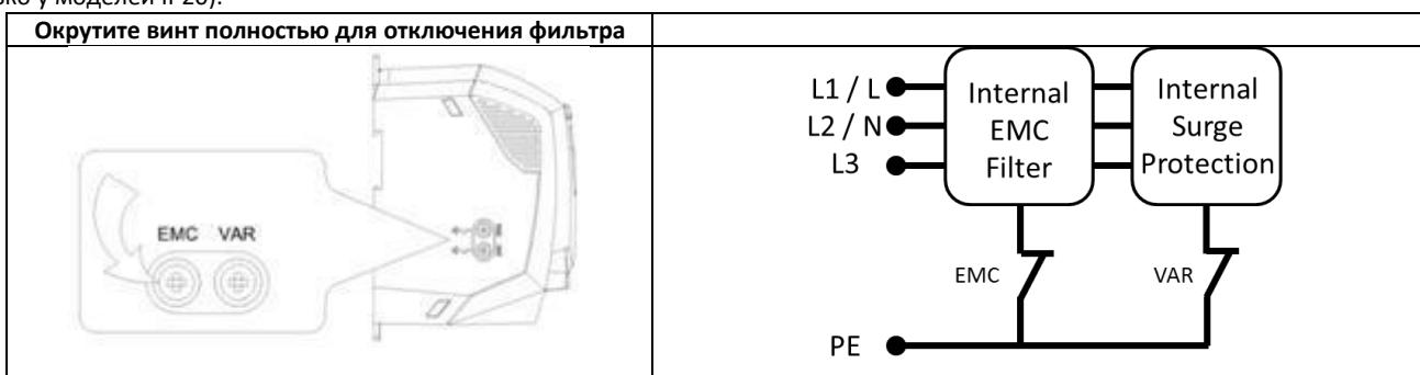
Преобразователи частоты Optidrive во входной цепи имеют элементы защиты от импульсных перенапряжений со стороны сети, обычно возникающих при ударном включении/выключении мощного оборудования (например, мощные асинхронные двигатели с прямым пуском), находящегося на одной линии питания с приводом.
