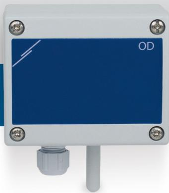
ODXT серия - это датчики / переключатели температуры наружного воздуха. Четыре предварительно установленные диапазоны измерения и один выбираемый диапазон, позволяют клиенту установить подходящий диапазон измерения. Этот датчик / переключатель имеет последовательный RS485 порт (Modbus RTU), один релейный выход и один аналоговый / цифровой выход (0—10 В / 0—20 мА / ШИМ). Эти датчики / переключатели компенсированные по температуре и отличаются высокой степенью точности и надежности.
