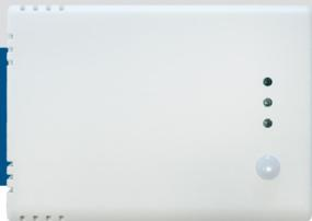
RCMFH-2R - це інтелектуальні багатофункціональні кімнатні датчики, вибір діапазону температури, відносної вологості і  $\text{CO}_2$ . Алгоритм управліє одним аналоговим / модулюючим виходом на основі вимірюваних значень  $T$ ,  $rH$  і  $\text{CO}_2$ , які можна використовувати для безпосереднього управління EC вентилятором або приводом заслінки. Живлення 24 VDC і датчик зовнішньої освітленості. Всі параметри доступні через Modbus RTU.
